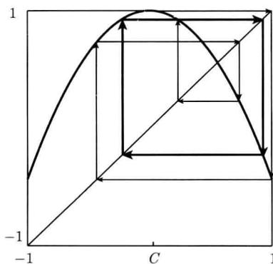
图 6.14  $RLRR(RL)^\infty$  对应的同宿轨道
