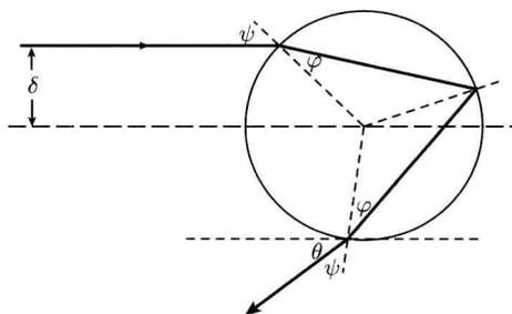
图 2.7 光束在水珠中的折射和反射
